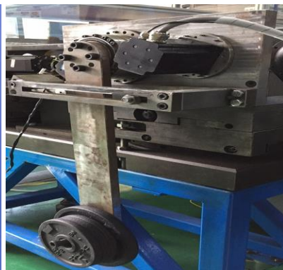
机器人电机试验平台
