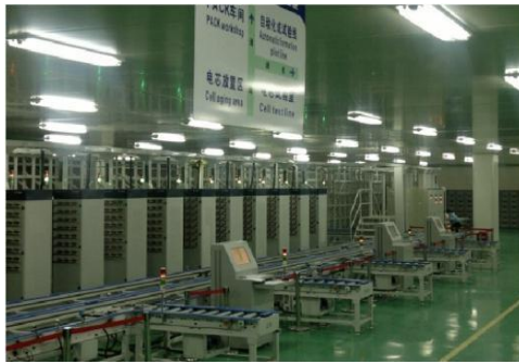
动力锂离子蓄电池化成自动化生产线
